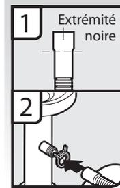
1. Connecter l'extrémité noire du tuyau d'évacuation sur le raccord T du circuit de plomberie; couper si nécessaire (ne pas couper dans la section ondulée).
